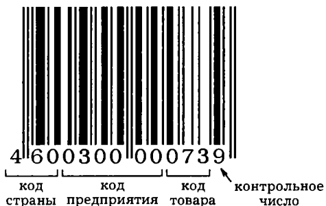
Рис. 66. Код EAN-13. Внешний вид и структура. В основном применяется для кодирования товаров народного потребления
