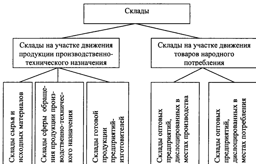
Рис. 108. Классификация складов по признаку места в общем процессе движения материального потока от первичного источника сырья до конечного потребителя
