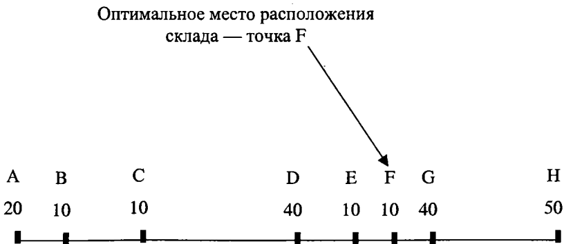
Рис. 116. Определение оптимального места расположения склада на участке обслуживания методом пробной точки (числами указан грузооборот потребителей, тонн в месяц)
